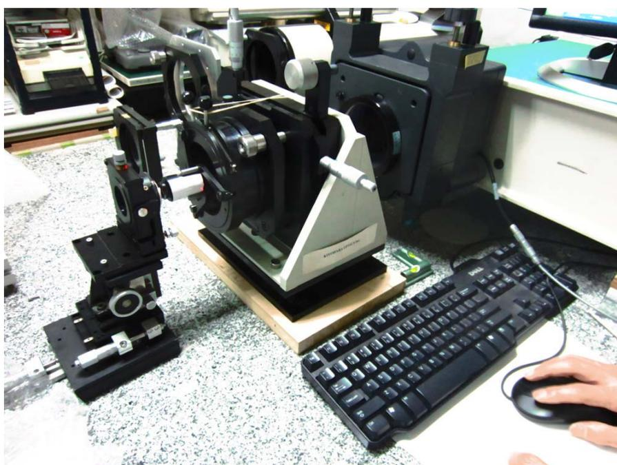
図4 光学性能評価用装置(MTF測定用)
